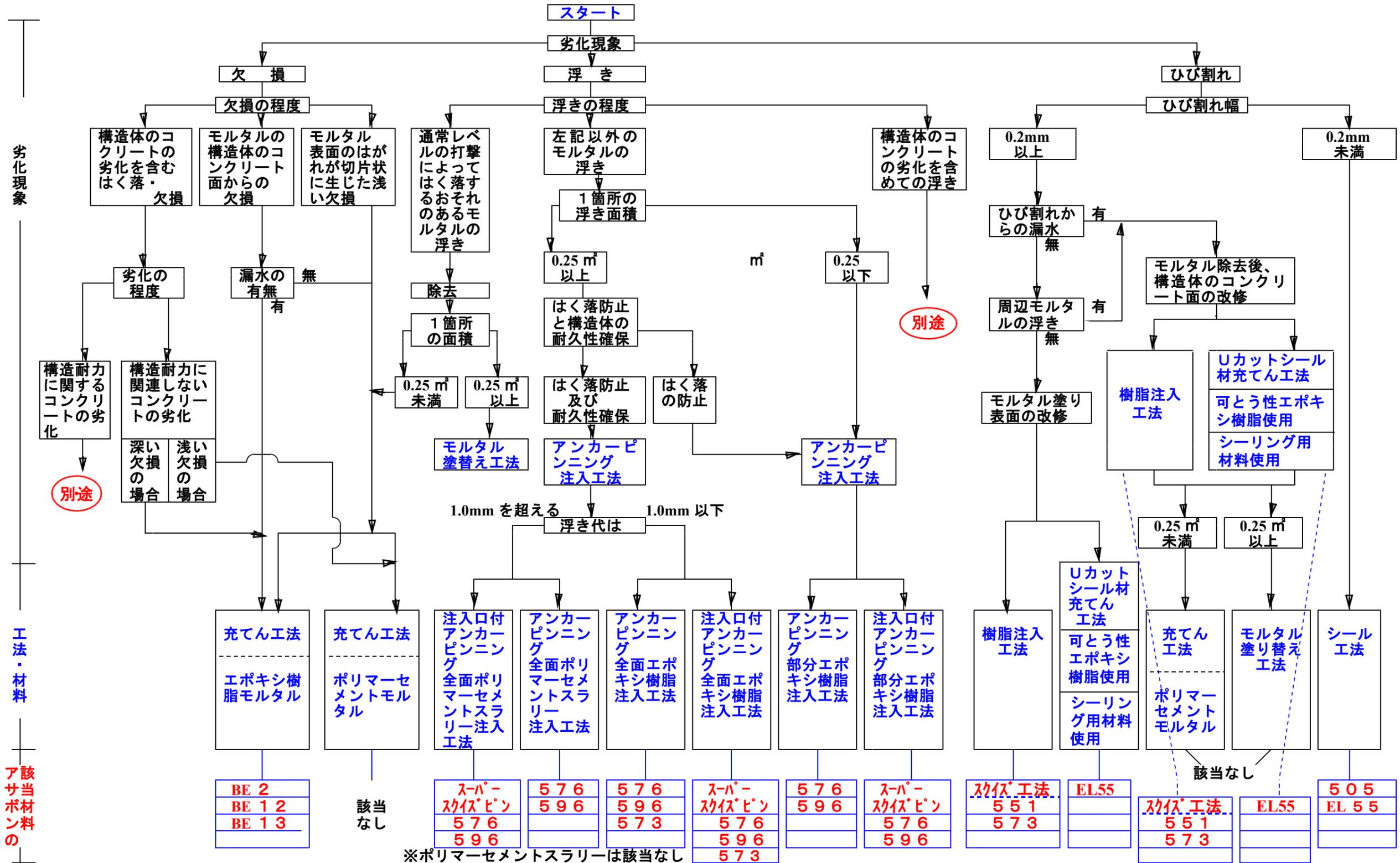
3. タイル張り仕上げ外壁（手張り工法）の改修工法選定フロー ※各工法名をクリックすると施工要領書Excelが開きます。
